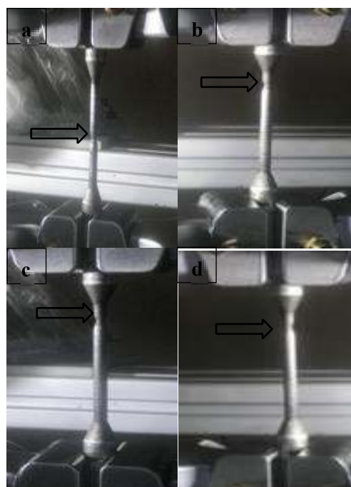
Gambar 4. Foto Hasil Sample Setelah Di Uji Tarik Spesimen Baja AISI 1045 (a) Tanpa Perlakuan (b) tempering suhu 450 °C, (c) Tempering suhu 550 °C, dan (d) Tempering Suhu 650 °C
