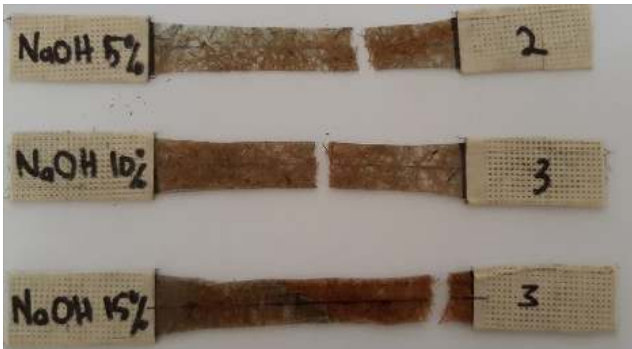
Gambar 3. Sampel uji tarik komposit serat kelapa 5 wt%; 10 wt %; 15 wt%
