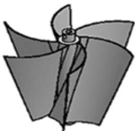
Gambar 5. Skema turbin vortex .
