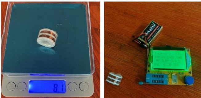
Gambar 6. Cuplikan kegiatan pengujian koil untuk mengukur berat, resistensi dan induktansi.
