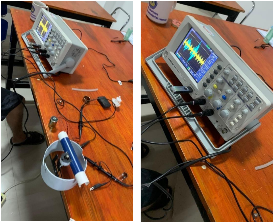
Gambar 7. Pengujian rancang bangun koil dengan menggunakan pegas pada platform sederhana menggunakan osiloskop.
