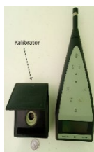
Gambar 4. Sound level meter Bruel & Kjaer tipe 2239 dan kalibrator
