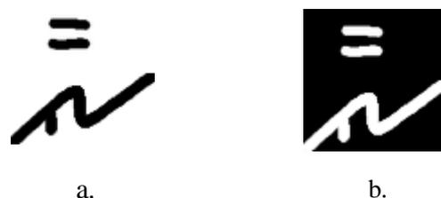
Gambar 5. Hasil proses slicing dan inverting, a. sebelum dilakukan slicing dan inverting, b. setelah dilakukan proses slicing dan inverting.
