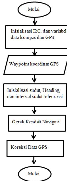
Gambar 8. Diagram Alir Pemrosesan Data Sistem Navigasi Waypoint
